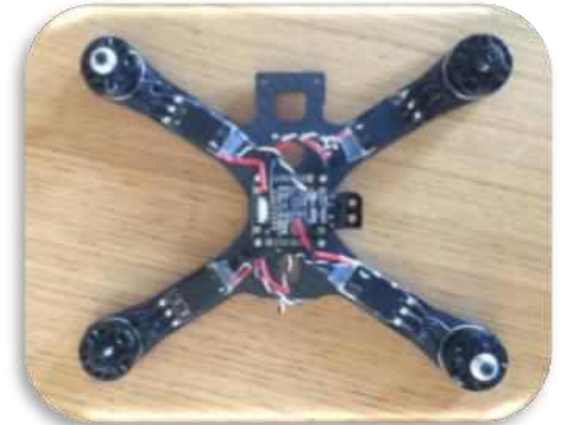
Мал. 2.10. Електронні регулятори обертів, закріплені на променях рами
