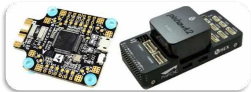
Мал. 2.12. Види польотних контролерів: а) – ПК FPV-дрона; б) – автопілот БПЛА
