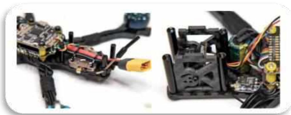
Мал. 5.5. Монтаж відеопередавача та камери на БПЛА
