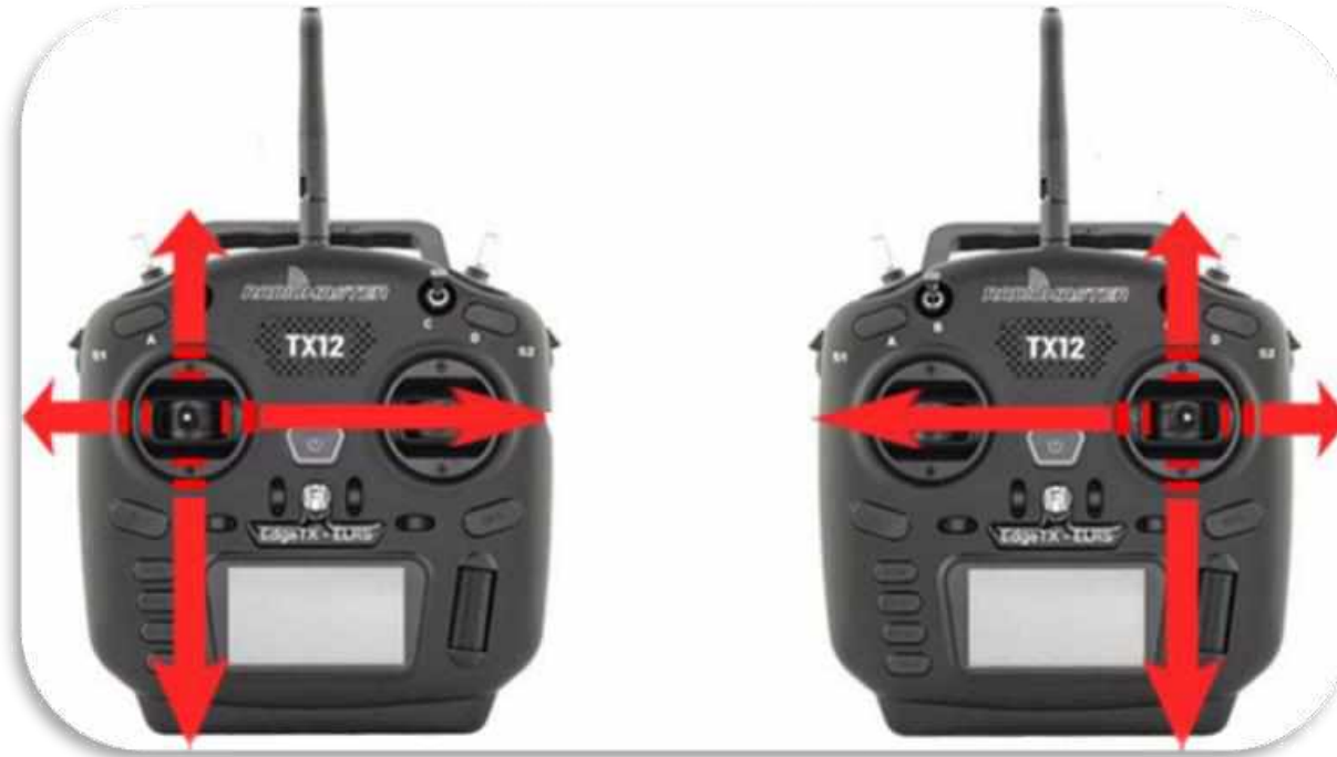
Мал. 3.2. Режим роботи пульта керування MODE 2
